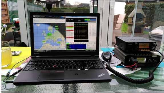
Digitalbetrieb per JS8Call als Digimode auf dem 11m-Band der oberen Kurzwelle: nicht nur Computer kommunizieren untereinander, sondern auch Menschen per Funk-Chat und per Sprache. Laptop mit Software, Funkgerät, Antenne und 12V-Stromquelle. Mehr braucht man nicht und man erreicht ganz Europa.
